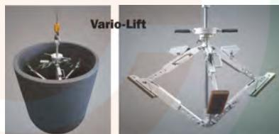
**5 - Type X-LIFT:** Préhension des creusets neufs et usagés de l'extérieur et se resserme automatiquement lors du levage. Nécessite seulement 25 mm entre le creuset et le revêtement du four. Ce type est l'alternative la plus sûre à l'installation et au retrait des creusets
