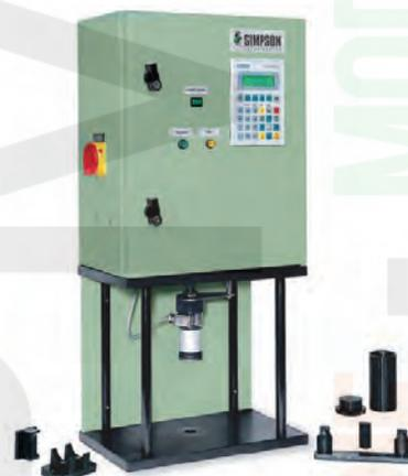
**Duromètre électronique de moules type PFP. Référence 338.101**
