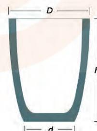
**Creusets de fusion en SIC, (carbure de silicium) fabriqués par pressage isostatique.**
