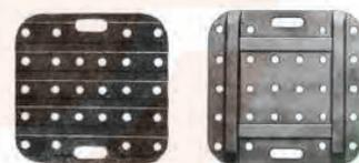
**Plateaux de séchage, pour noyaux.**
