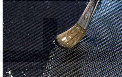
Biresin® CR82 avec viscosité optimisée pour les moulages au contact
