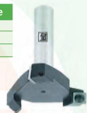
**6 - Porte-outils à chanfreiner.** Particulièrement adapté au dressage et chanfreinage suivant un angle réglable sans palier. Plaquettes réversibles Z 2. Vernier bien lisible pour un réglage précis et rapide de l'angle du chanfrein. La pièce peut être usinée par dessus ou par dessous. La grande plage de réglage de 0 - 85° permet aussi la réalisation de plate-bandes. Adaptation du type de carbure au matériau à usiner par simple échange des plaquettes.
