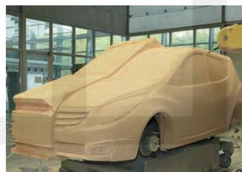
Modèle de voiture grandeur nature réalisé avec des planches SikaBlock® M330 assemblées avec Biresin® Kleber Orange
